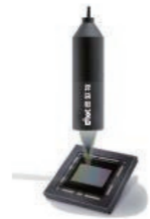
测量CMOS的倾斜和缝隙
