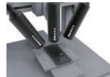
测量手机曲面玻璃的形貌
