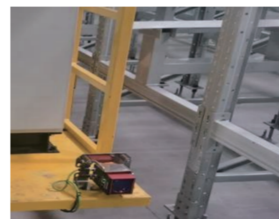
车库载车台 移动距离测量
