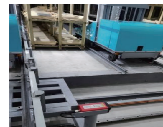
车库载车台 移动距离测量
